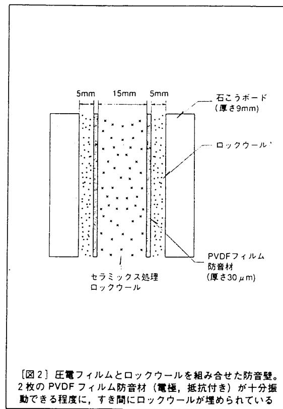
[図2] 圧電フィルムとロックウールを組み合せた防音壁。
