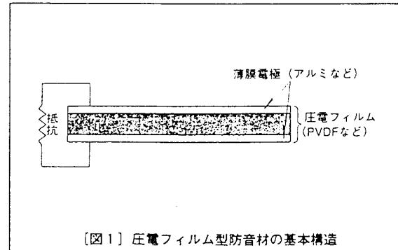
[図1] 圧電フィルム型防音材の基本構造
