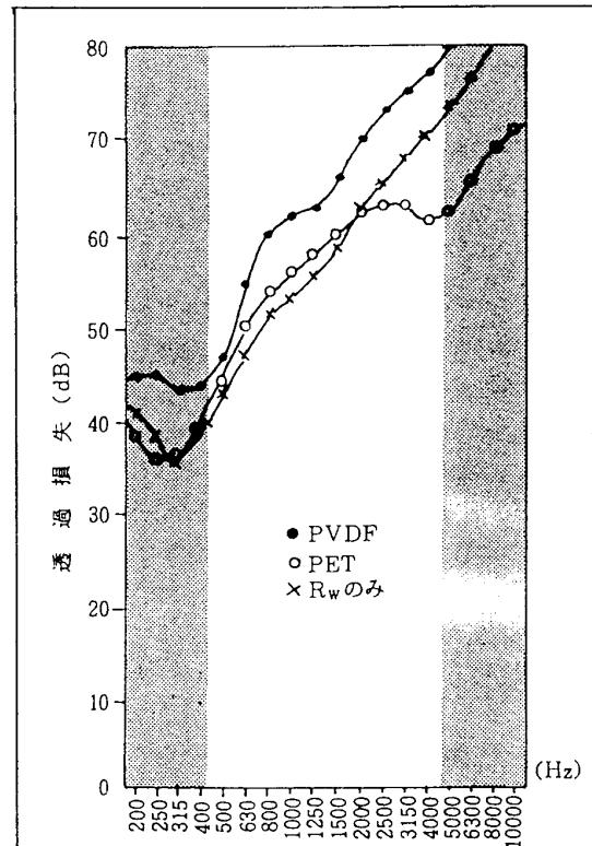
[図3] 圧電フィルムを用いた吸遮音構造体の音響透過損失
