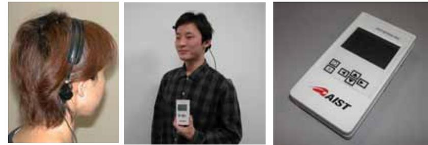
図 4-2 携帯型骨導超音波補聴器
