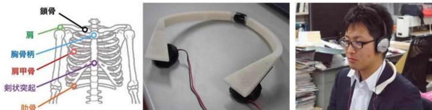
図 1. (左)主観的な振動伝播性の調査部位 (中央)製作した鎖骨振動呈示デバイス (右)デバイス装着の様子
