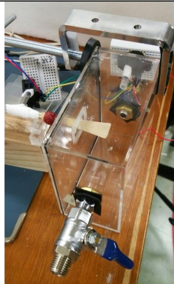
図2 剛性測定装置の写真 (人工吹鳴実験用に改造)
