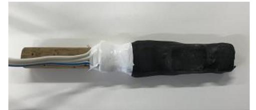
**【実験】**被験者は、指定された音をまず片持ち梁式力覚センサーリードで音を出しながら演奏し(右図)、その後すぐに両持ち梁式模擬リードで演奏を行う。両持ち梁式模擬リードは音が鳴らないため、表面筋電図から得られる口輪筋の活動強度を片持ち梁式力覚センサーリードのそれと比較することで、両方のリードで奏者が同じパフォーマンスを行っていたことを確認する。歪ゲージからの信号は応力アンプを介して、増幅後、AD変換器を介してPC内に取り込む。表面筋電図から得られる信号も同様にAD変換後PC内に記録する。また演奏音の信号も楽器正面に配置した騒音計を使用し、PC内に同時記録する。サンプリング周波数は1kHzとした。演奏に用いる音は4つの音高(D4=293Hz、A4=440Hz、D5=587Hz、A5=880Hz)と2つの音量( $p$ または $mf$ )を組み合わせた8種類の音とし、被験者はそれぞれの音を2秒演奏し2秒休みを6回繰り返した。
