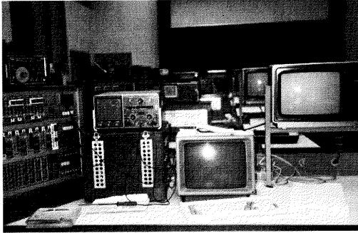
ENSTの学生実験室 論理回路の実験演習では学生ひとりひとりがこのような装置を与えられて実験している。中央のディスプレイ端末は学科のVAX750に接続されている。
