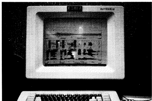
Symbolics のディスプレイ。Spire による分析結果が表示されている。
