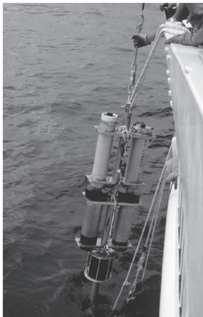
写真1 音波の送受波器の投入風景
